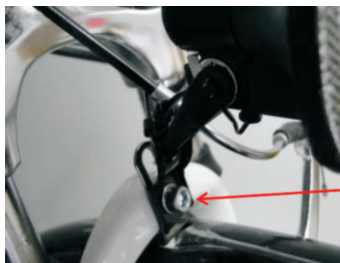
ŚRUBA MOCUJĄCA UCHWYT LAMPY I BŁOTNIKA PRZEDNIEGO
