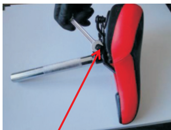
NAKRĘTKA MOCUJĄCA SIODEŁKO DO WSPORNIKA SIODŁA
