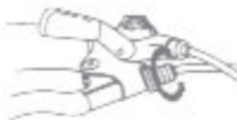
rys. 12a regulacja napięcia linki hamulca
