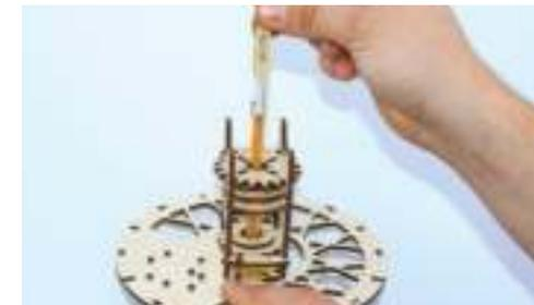
**RU** Крючок для продевания резинок. **UKR** Гачок для протягування гумок. **ENG** Hook for threading rubber bands. **DEU** Hacken für Einziehen der Gummibänder. **FRA** Crochet pour l'enfilage des élastiques. **POL** Hak do przeciągnięcia gumek. **SPA** Gancho para dejar pasar tiras de goma. **ITA** Gancio per infilare le gomme. **TUR** Lastik geçirme kancası.
