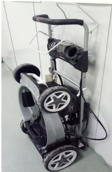
Przechowanie kosiarki w pozycji pionowej
