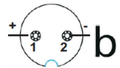
Terminal zasilania na ładowarce
