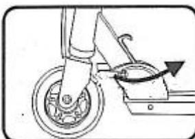
6. Зафиксируйте блокирующий механизм.
