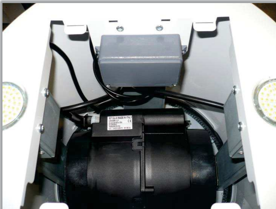
Fot.3 Ulokowanie ceowników mocowania względem dolnego korpusu.
