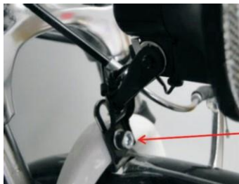
ŚRUBA MOCUJĄCA UCHWYT LAMPY I BŁOTNIKA PRZEDNIEGO
