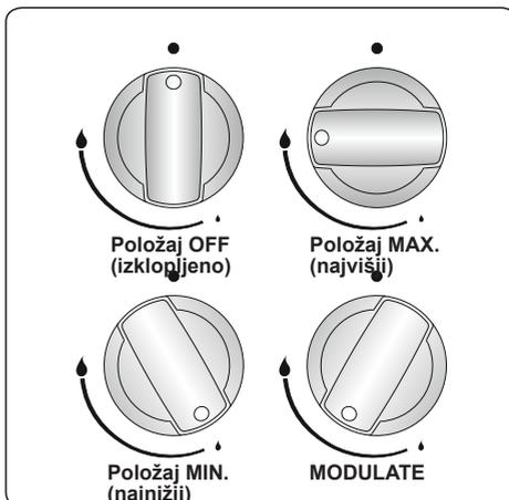
Po vžigu vizualno preverite plamene. Če vidite rumeno konico, dvignjen ali nestabilen plamen, izklopite pretok plina in preverite namestitvev kavic in kron gorilnika, ko se ohladijo. Prepričajte se, da v kavicah gorilnika ni tekočine. Če plamen gorilnika nenamerno ugasne, izklopite gorilnik, prezačite kuhinjo in pred ponovnim vžigom počakajte vsaj 90 sekund.
