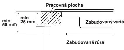
Ak rúru inštalujete pod varič, vzdialosť medzi pracovným povrhom a horným panelom rúry musí byť minimálne 50 mm a vzdialenosť medzi pracovným povrhom a vrchom ovládacieho panela musí byť minimálne 25 mm.
