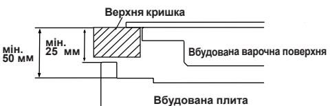
Якщо духовка встановлюється під варочною поверхнею, відстань від робочою поверхнею та духовкою має бути не менше ніж 50 мм, а між робочою поверхнею та верхом панелі керування — не менш ніж 25 мм.
