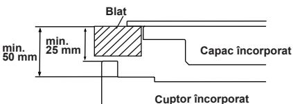
Dacă instalați cuptorul sub o poliță, distanța între blatul de lucru și panoul de sus al cuptorului trebuie să fie de minimum 50 de milimetri, iar distanța între blatul de lucru și partea superioară a panoului de control trebuie să fie de minimum 25 de milimetri.
