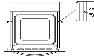
Ubacite rernu u ormarić tako što će je gurnuti napred. Otvorite vrata rerne i ubacite 2 šrafa u rupe koje su locirane na okviru rerne. Dok okvir proizvoda dodiruje drvenu površinu ormarića, zategnite šrafove.
