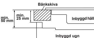
Om ugnen installeras under en häll, måste avståndet mellan bänkskivan och den övre panelen på ugnen vara minst 50 mm och avståndet mellan bänkskivan och toppen av kontrollpanelen måste vara minst 25 mm.
