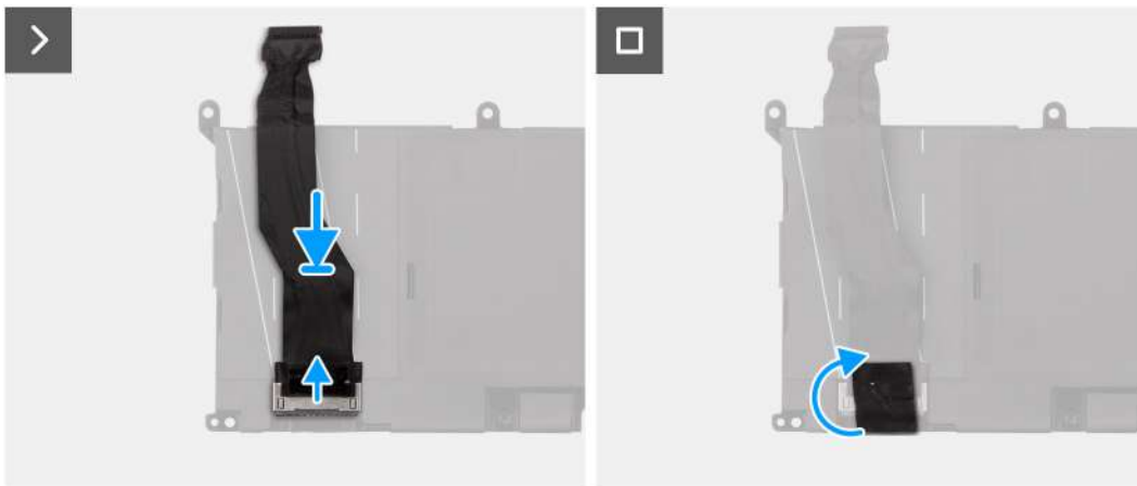
Instalowanie kabla baterii
