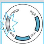
Дисплей бритвы <sup>14</sup> показывает уровень зарядки аккумулятора. Во время зарядки или во время использования бритвы, соответствующий зеленый сегмент зарядки начнет мигать. При полной зарядке оба сегмента зарядки будут постоянно гореть при условии включенной или подключенной бритвы к электросети.
