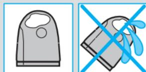
Jedinica sadrži visoko zapaljivu tekućinu. Ne držite je u blizini zapaljivih tvari ili izvora vatre. Nemojte je izlagati izravnoj sunčevoj svjetlosti ili pušiti u blizini niti je spremajte iznad radijatora. Držati izvan dohvata djece.
