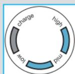
Na wyświetlaczu golarki ⑭ wyświetlany jest poziom naładowania akumulatora. Podczas ładowania lub golenia wyświetlany jest migający zielony segment. Gdy golarka jest całkowicie naładowana, oba segmenty poziomu naładowania akumulatora będą się świecić przez cały czas, pod warunkiem, że golarka będzie włączona lub podłączona do gniazdka elektrycznego.
