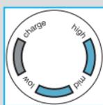
Displej holicího strojek ⑭ ukazuje úroveň nabití baterie. Při dobíjení nebo při použití holicího strojek bude příslušný bateriový segment zeleně blikat. Při plném nabití budou oba dobíjecí segmenty neustále svítit (pokud bude holicí strojek zapnutý nebo zapojený do elektrické zásuvky).
