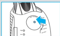
Když základna zvolí jedno z potřebných čištění, nedojde k jeho spuštění do doby, než zmáčknete tlačítko «start cleaning» ④.
