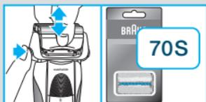
Keď nadstavec s planžetou a žiletkami vymeníte, vynulujte displej strojčeka pomocou guľôčkového pera tak, že stlačíte tlačidlo na vynulovanie ⑬ aspoň na 3 sekundy. Indikátor pre výmenu dielov počas tohto úkonu svieti a vypne sa, keď sa vynulovanie dokončí. Manuálne vynulovanie môžete urobiť kedykoľvek.
