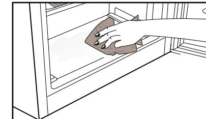
Med odtajanjem naj bodo vrata odprta. Za hitrejši odtajanje lahko v napravo postavite posode s toplo vodo.
