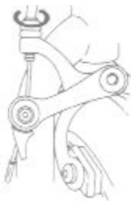
rys. 12b regulacja napięcia linki hamulca
