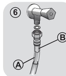
● **АКВАПРОТЕКТ** («Система захисту від протікання») – ВОДОНАЛИВНИЙ ШЛАНГ З ДОДАТКОВИМ ЗАХИСТОМ (Рис.6): Якщо вода протече з головного внутрішнього шлангу «A», то вона потрапить до прозорої захисної зовнішньої оболонки «B», що дозволить закінчити цикл прання. Після завершення циклу прання зверніться до Центру з Обслуговування Клієнтів, щоб замінити водоналивний шланг.
